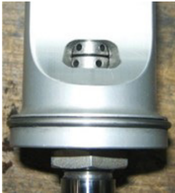
Kuva: Yksiputkivaimennin kahdella säädöllä
