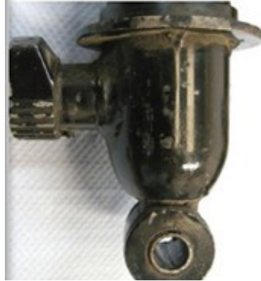
Kuva: Armstrong-vaimennin yhdellä kahteen suuntaan vaikuttavalla säädöllä
